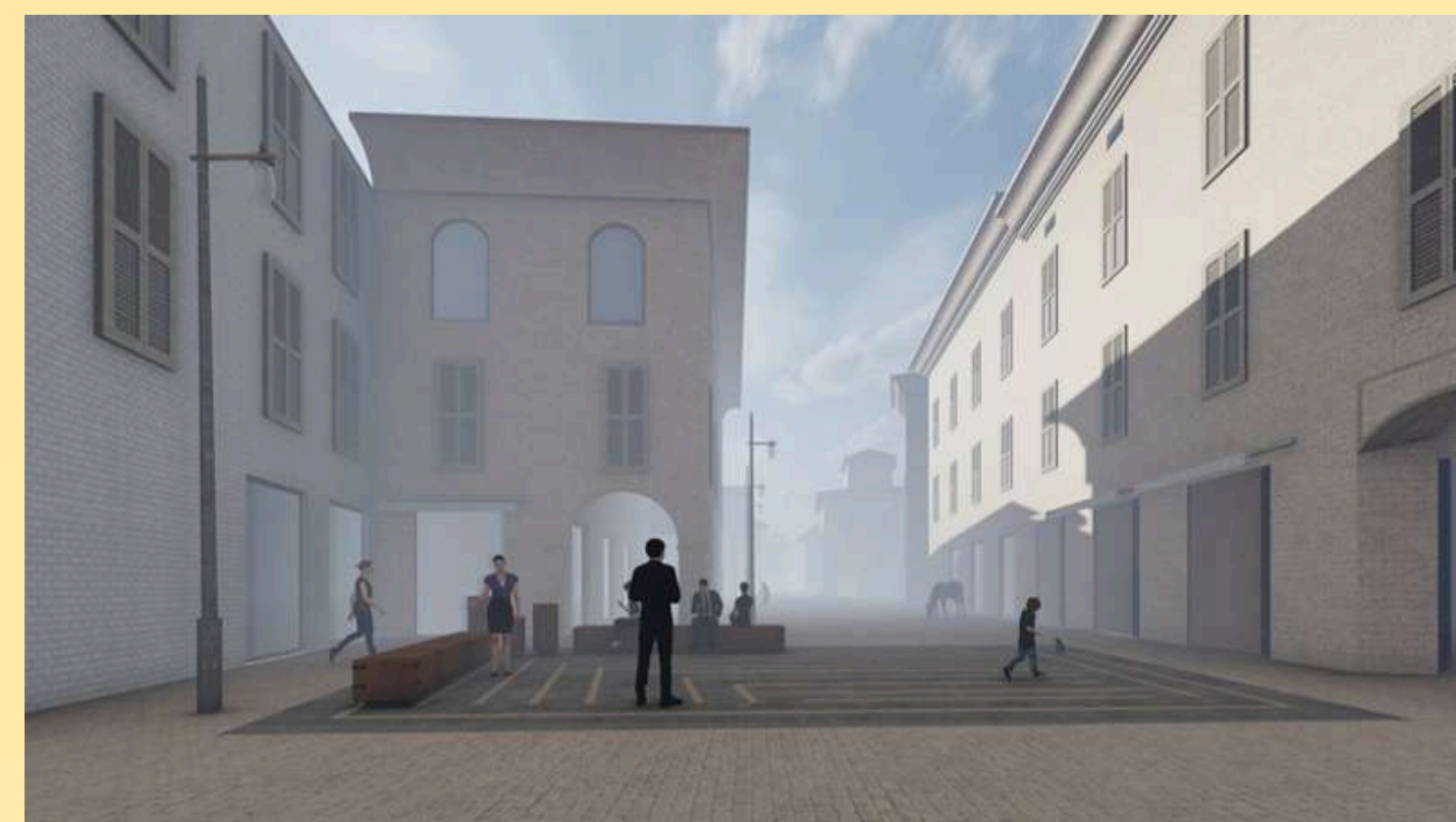
Nuova pavimentazione e nuovo arredo urbano in via Garibaldi. Il sistema di arredo urbano è fatto di sedute, dissuasori, cestini e portabiciclette realizzati in acciaio Corten in perfetta armonia con i colori delle murature storiche in laterizio
