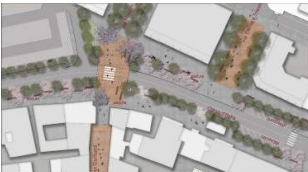
Corso D'Italia, ampliamento dei marciapiedi con mantenimento della pavimentazione esistente e reimpiego di lastre da demolizioni
